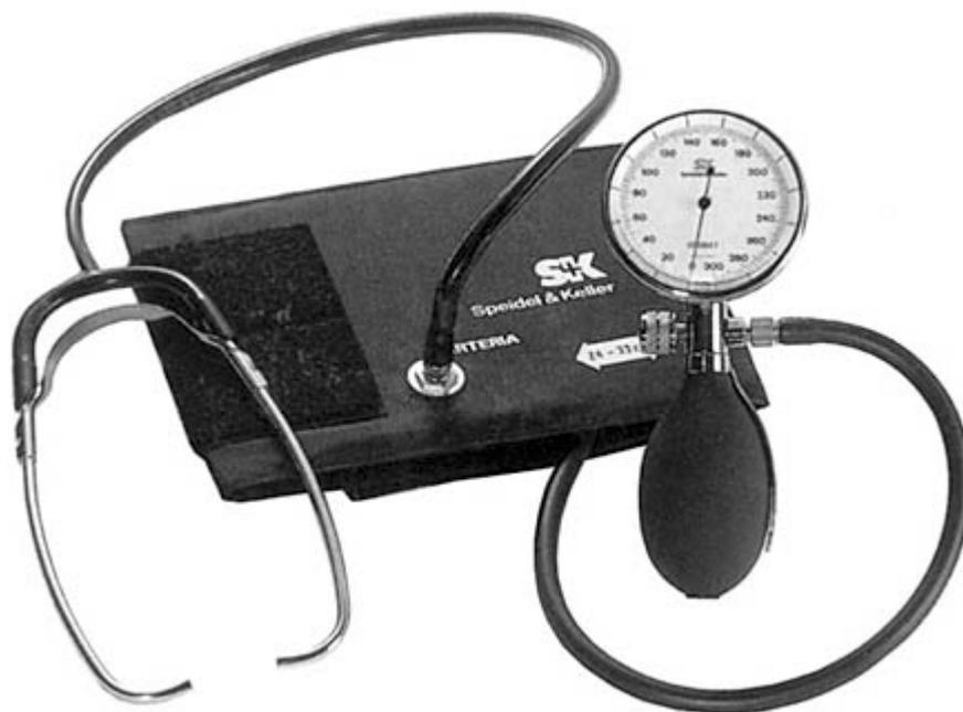
Slika 1: Fotografija tlakomjera tip Primus home
